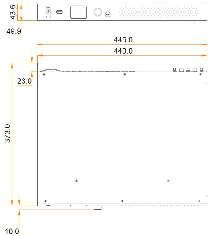
Погрешность: ±0.3 ед. измерения: мм
