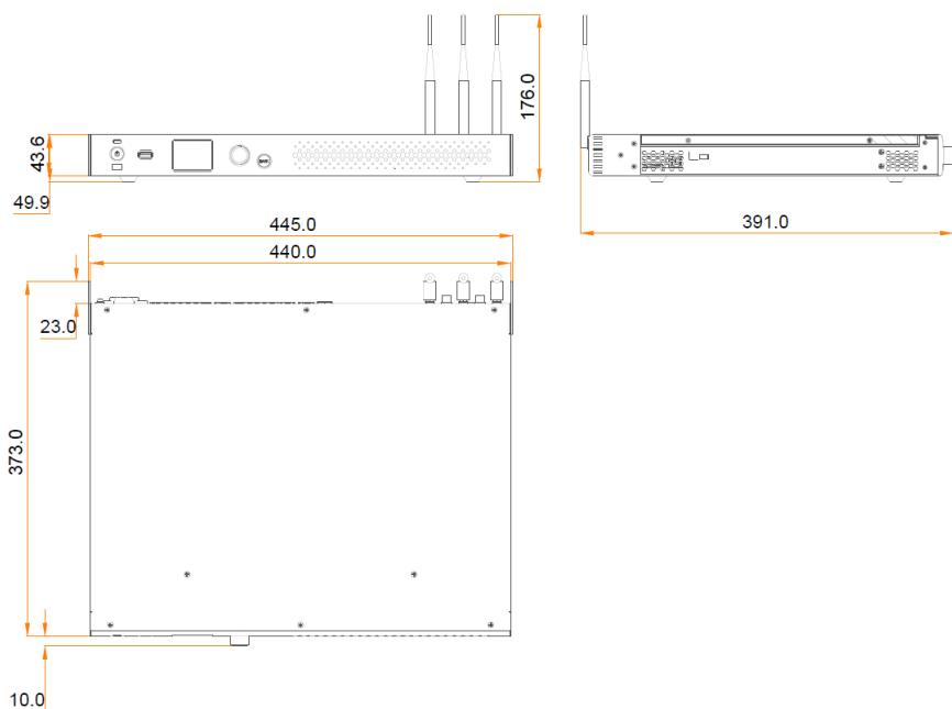
Погрешность: ±0.3 ед. измерения: мм
